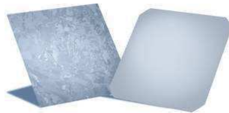
Figure 1-5 : Wafers multicristallin (gauche) et monocristallin (droite)
