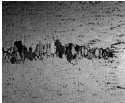
Figure I-10: Exemple de formation d'une macroségrégation du type freckle au sein d'un superalliage de Nickel (Courtesy A. & Giamei F.)
