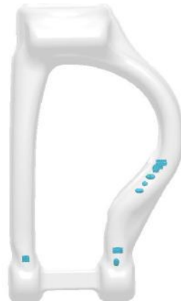
Figure V-13 : Résultats de simulation sous MagmaSoft de la localité des retassures internes (représentée en bleu)
