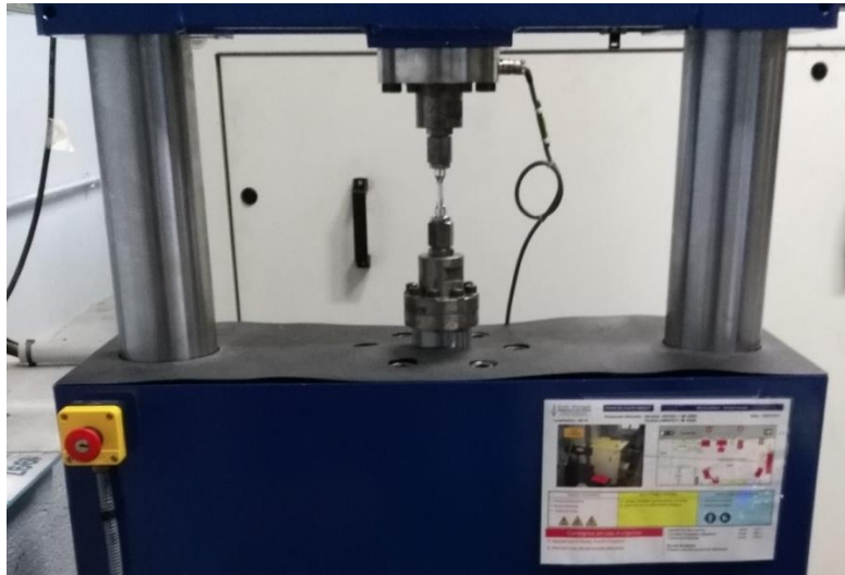
Figure II-9 : Montage essai de fatigue
