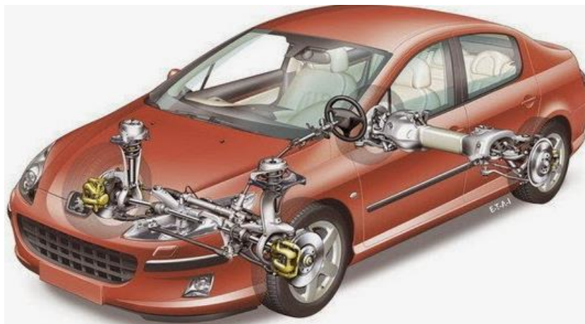
Figure 1 : Localisation des pièces liaison au sol dans une voiture
