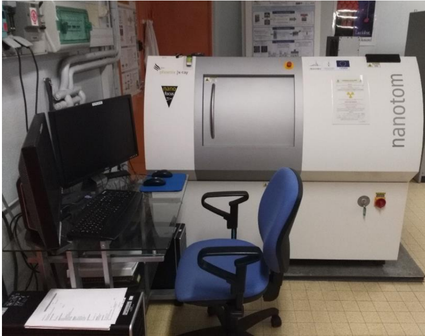
Photo II-1 : Appareil de Tomographie X du centre SPIN de l'Ecole des Mines de Saint-Etienne
