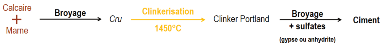
FIGURE I.1 – Schéma simplifié du procédé de fabrication du ciment Portland
