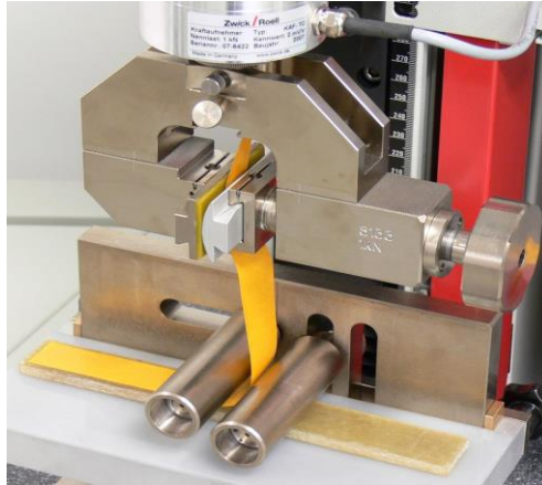
Figure I.12. Machine de pelage automatisé ( www.zwickroell.com ) [36].
