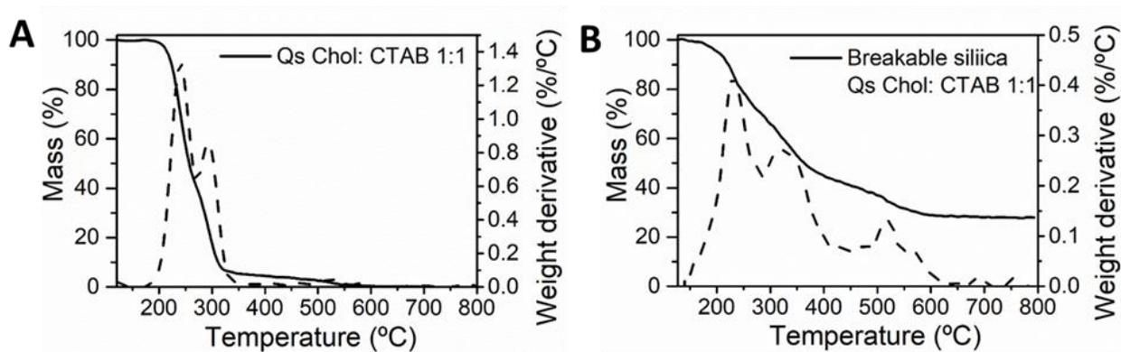
Figure 3.42. TGA of the A) QS and B) breakable silica QS.
