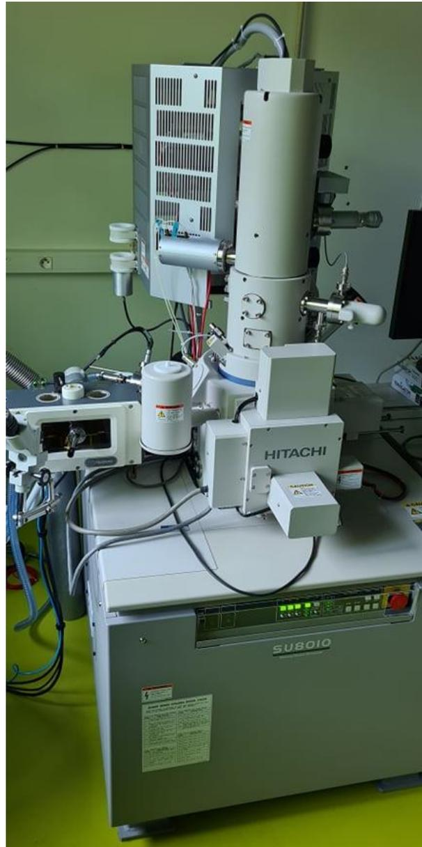
**Figure 2.29.** Vue générale : Microscope électronique à balayage à ultra-haute résolution SU8010 HITACHI 3.
