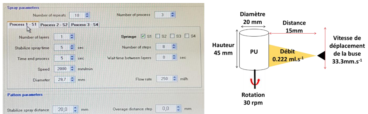
Figure 2.20. (gauche) photographie de l’écran du logiciel contrôlant le dispositif de pulvérisation présentant toute les paramètres possibles à modifier ; (droite) Schéma des différents paramètres du dispositif de pulvérisation utilisés pour la pulvérisation des différentes solutions
