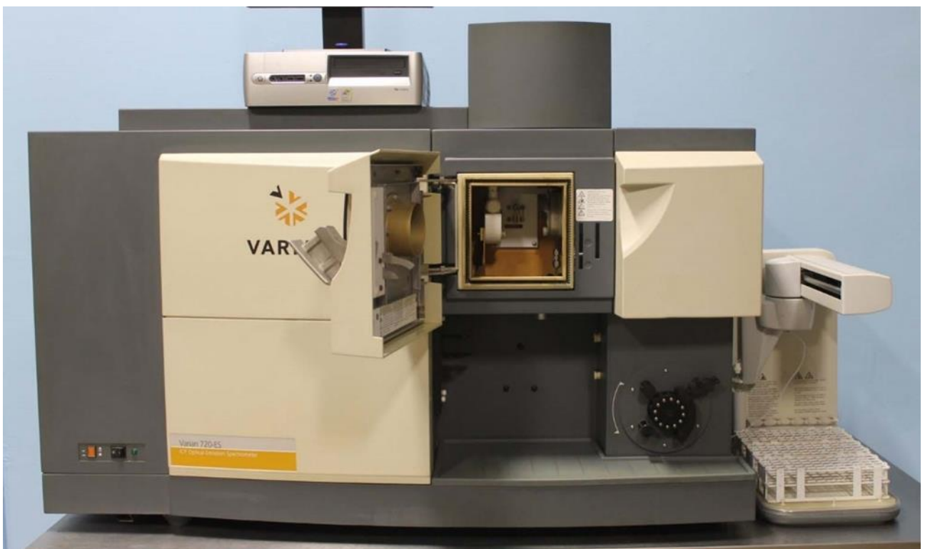
Figure 2.31. Vue générale d'un spectromètre par torche à plasma modèle Variant 720 ES instrument.
