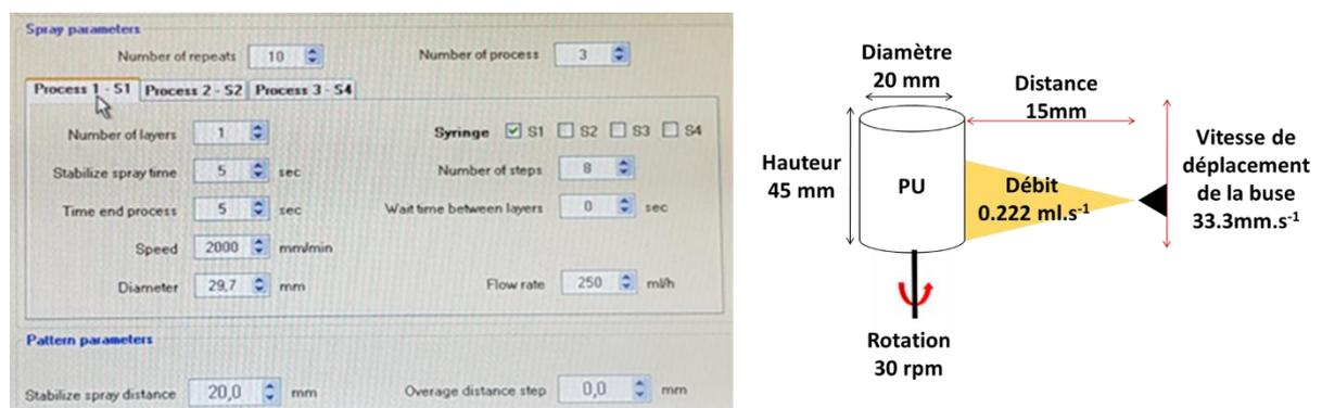
**Figure 2.20.** (gauche) photographie de l’écran du logiciel contrôlant le dispositif de pulvérisation présentant toute les paramètres possibles à modifier ; (droite) Schéma des différents paramètres du dispositif de pulvérisation utilisés pour la pulvérisation des différentes solutions
