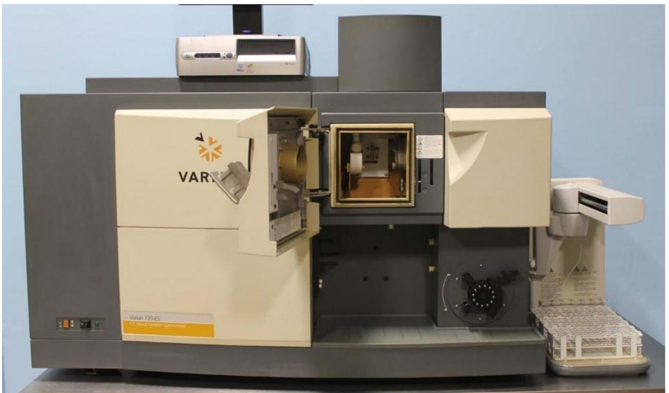
**Figure 2.31.** Vue générale d'un spectromètre par torche à plasma modèle Variant 720 ES instrument.
