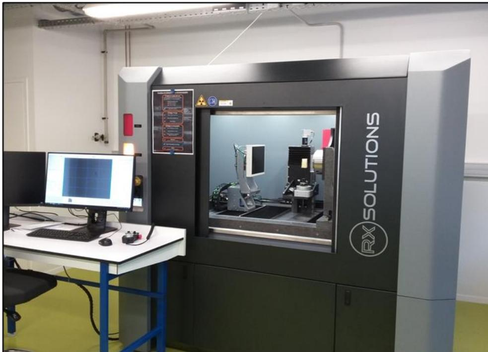
**Figure 2.35.** Vue générale : (gauche) ordinateur utilisé pour la gestion du tomographe ; (droite) cabine (radio-protection contre les rayonnements ionisants)
