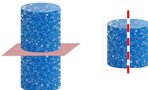
**Figure 3.9.** Représentation schématique de la découpe des mousses après dépôt de PDA, dans le sens de la largeur et de la hauteur pour observer sur le revêtement s'est formé également au centre de la mousse.
