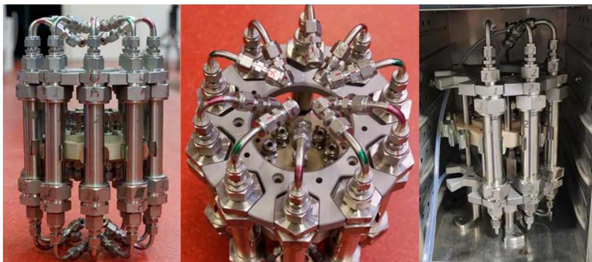
Figure 5.25. Photographie d'un carrousel fabriqué à l'atelier mécanique de l'institut pouvant tenir jusqu'à 10 réacteurs tubulaire qui peuvent être branché en série ou en parallèle
