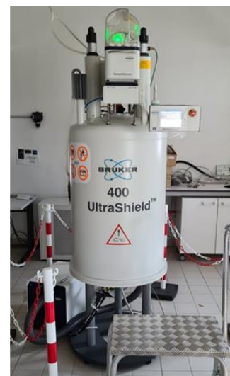
Figure 2.40. (gauche) Schéma représentant le fonctionnement d'un spectromètre RMN; (droite) photographie Brücker Advance III HD 400MHz
