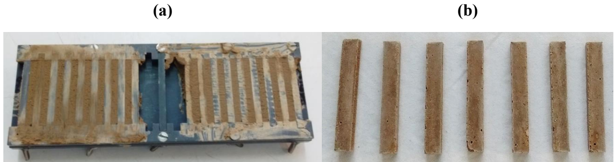
Figure 46: Photographies (a) des moules prismatiques après coulage et (b) échantillons prismatiques après démoulage
