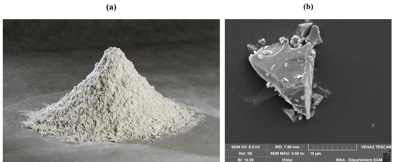
Figure 34: (a) Photo du laitier de haut fourneau sous forme de poudre [236] et (b) Image MEB d'un grain de laitier anhydre
