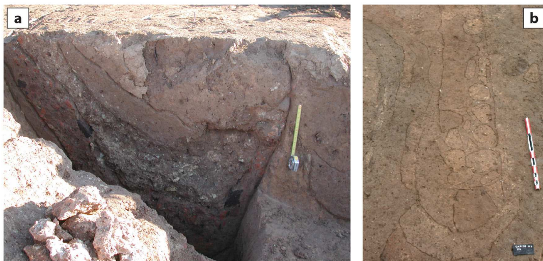
Fig. 2.15 – Structures identifiées dans les sites à réseau de fossés : (a) comblement de fossé formé par des apports d'origine majoritairement anthropique, Mas de Vignolles IV (Nîmes, Gard) (cliché J. Watez); (b) crête de mur réalisé en moellons de terre crue, apparu dans le comblement d'une structure fossoyée après décapage de l'horizon de labour sur le site de La Capoulière (Mauguio, Hérault), unité 4 (cliché L. Jallot; Guthertz et al. 2011, fig. 15).
