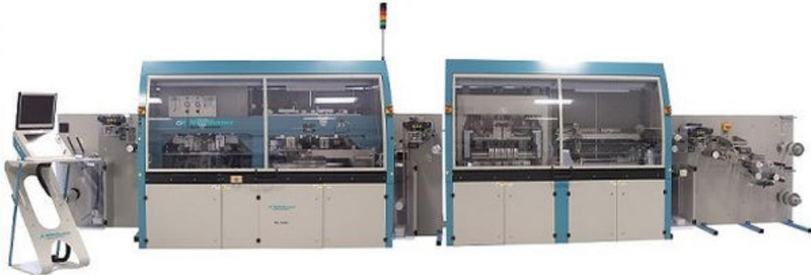
Figure 3-2 Banc de production automatique Muelbauer FCM10K
