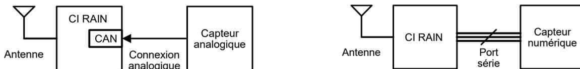
Figure 1-25 Diagramme du CI RAIN avec fonction de détection analogique (gauche) ou numérique (droite)
