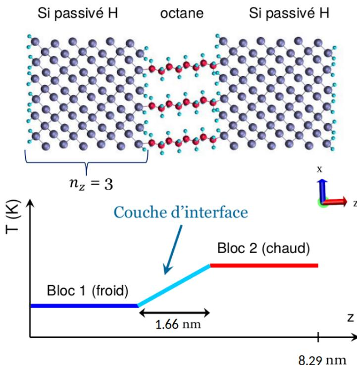
FIGURE 3.3 – Modèle *Silicium - Octane - Silicium* et schéma du profil de température visé avec 72 atomes de Silicium (Si - bleu) dans chaque bloc, 24 atomes de carbone (C - rouge) et 90 atomes d'hydrogène (H - bleu clair).
