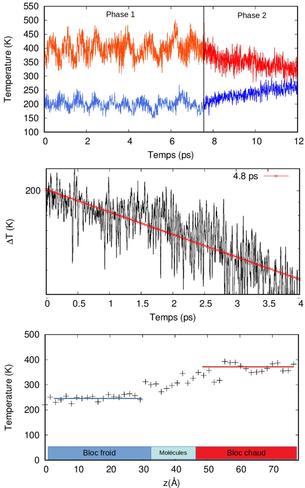
FIGURE 3.15 – Cas avec molécules contenant 6C : Trajectoires des blocs chaud (rouge) et froid (bleu) dans l’approche AEMD (haut). Évolution temporelle de la différence de température entre les deux blocs pendant la phase 2 de l’AEMD et ajustement par une exponentielle décroissante (milieu). Profil de température moyenné pendant l’intervalle [1-3] ps de phase 2 de l’AEMD (bas).
