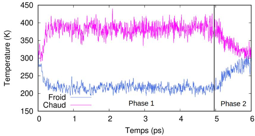
FIGURE 4.5 – Trajectoires des blocs chaud et froid dans la boîte de aSiO<sub>2</sub> de 558 atomes.
