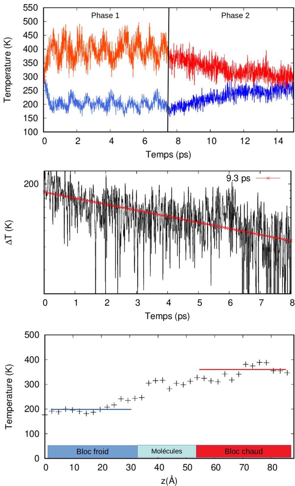
FIGURE 3.18 – Cas avec molécules contenant  $^{14}\text{C}$  : Trajectoires des blocs chaud (rouge) et froid (bleu) dans l’approche AEMD (haut). Évolution temporelle de la différence de température entre les deux blocs pendant la phase 2 de l’AEMD et ajustement par une exponentielle décroissante (milieu). Profil de température moyenné pendant l’intervalle [1-6] ps de phase 2 de l’AEMD (bas).
