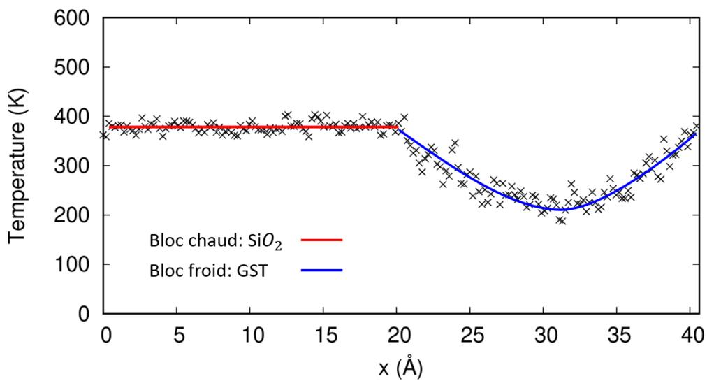
FIGURE 5.6 – Profil de température moyennée sur l'intervalle [1-5] ps de la phase 2 de la boîte aGST-aSiO<sub>2</sub> (points noirs). Ligne rouge : fit uniforme pour le bloc chaud, courbe bleu : fit sinusoïdal aux données pour le bloc froid.
