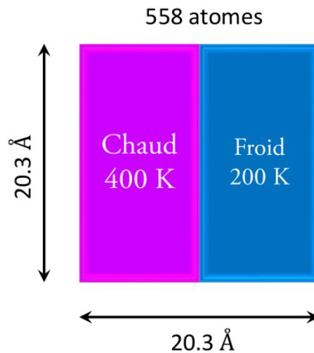
FIGURE 4.4 – Thermostats appliqués aux blocs chaud et froid.
