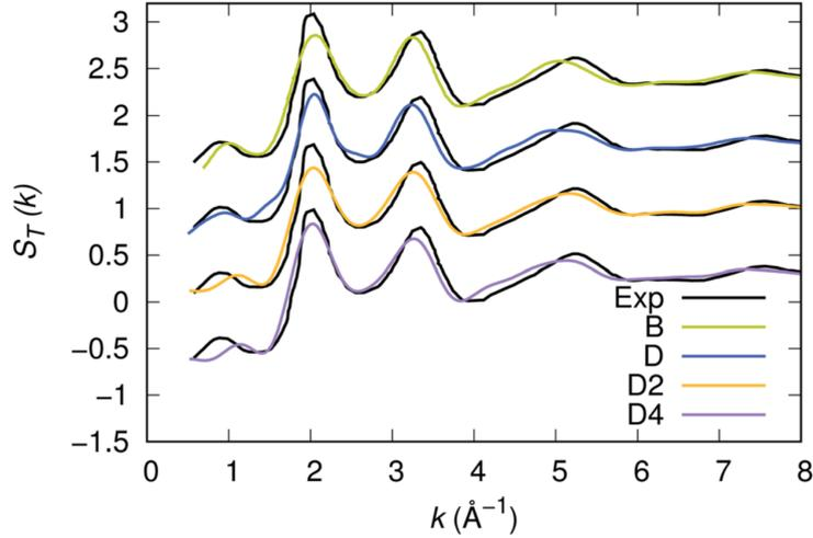
FIGURE 4.9 – Facteur de structure des neutrons  $S_T(k)$  expérimental [100] et calculé du GST amorphe. La quantité calculée a été obtenue par intégration dans l’espace réel de la fonction de corrélation de paires totales. [41]
