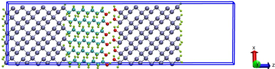
FIGURE 3.22 – Modèle atomique d’un système Si - molécules - Si impliquant des liaisons hydrogène. Les atomes de Si sont représentés en bleu, les C en turquoise, les O en rouge et les H en vert.
