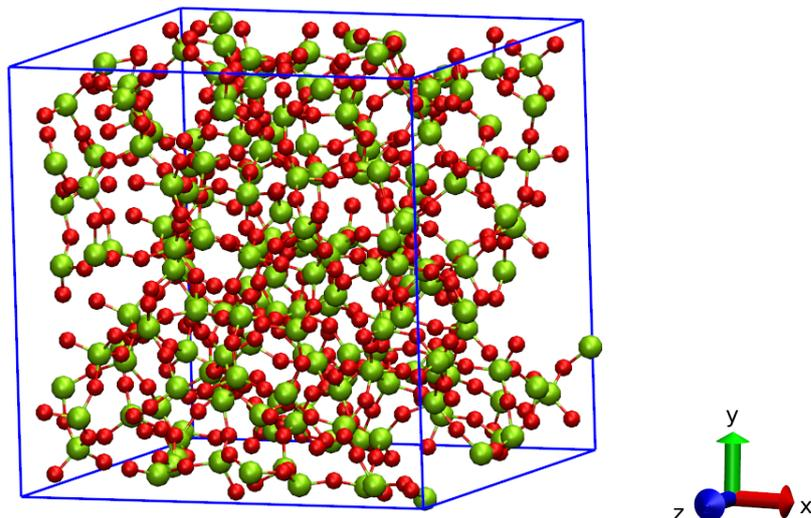
FIGURE 4.1 – Boîte cubique de aSiO<sub>2</sub> contenant 558 atomes. Les atomes de silicium sont représentés en vert, ceux d'oxygène sont en rouge.
