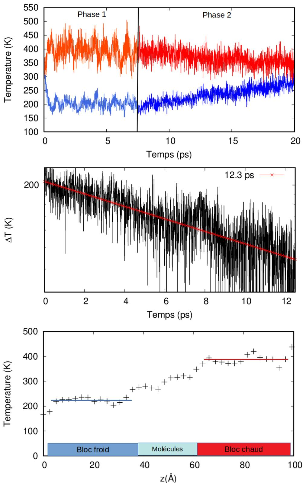
FIGURE 3.19 – Cas avec molécules contenant  $^{16}\text{C}$  : Trajectoires des blocs chaud (rouge) et froid (bleu) dans l’approche AEMD (haut). Évolution temporelle de la différence de température entre les deux blocs pendant la phase 2 de l’AEMD et ajustement par une exponentielle décroissante (milieu). Profil de température moyenné pendant l’intervalle [1-6] ps de phase 2 de l’AEMD (bas).
