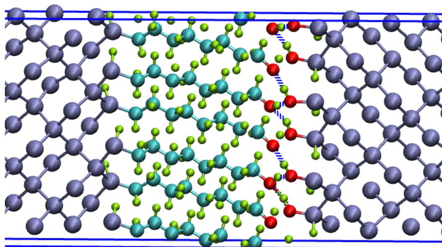
FIGURE 3.33 – Liaisons hydrogène à 300 K (lignes pointillées en bleu).
