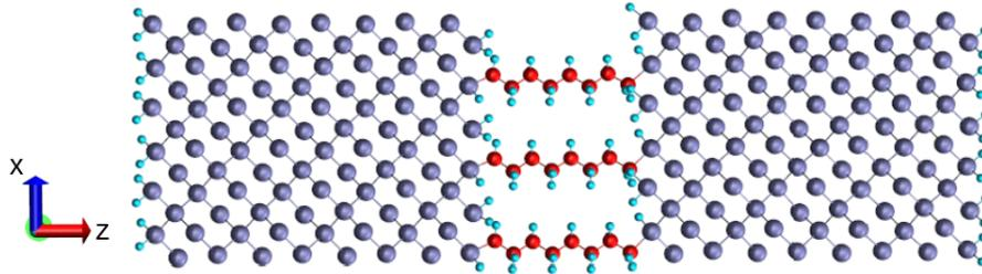
FIGURE 3.10 – Modèle de la structure *Silicium – Octane – Silicium* avec  $n_z = 4$  avec 96 atomes de Silicium (Si - bleu) dans chaque bloc, 24 atomes de carbone (C - rouge) et 90 atomes d'hydrogène (H - bleu clair).
