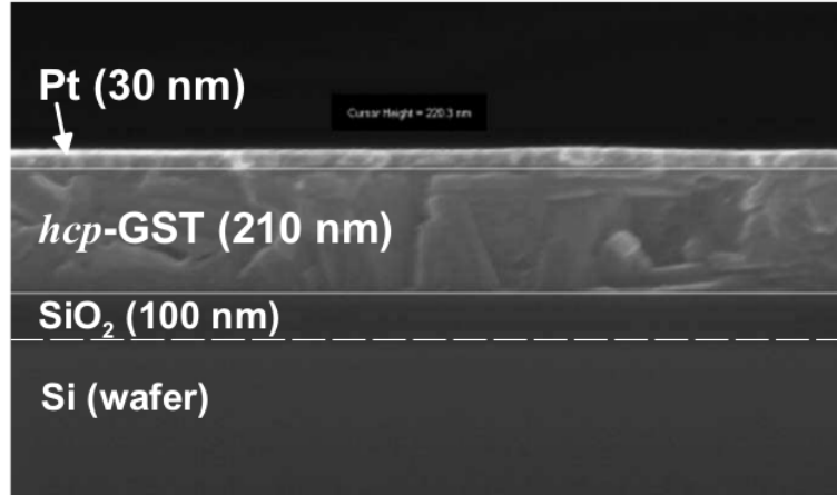
FIGURE 5.1 – Image en coupe SEM (Scanning Electron Microscopy) d’une multi-couche utilisée dans la Réf. [99] pour mesurer la résistance thermique à l’interface GST/SiO 2 .
