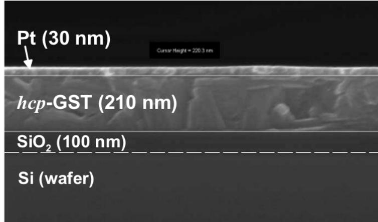
FIGURE 5.1 – Image en coupe SEM (Scanning Electron Microscopy) d’une multi-couche utilisée dans la Réf. [99] pour mesurer la résistance thermique à l’interface GST/SiO<sub>2</sub>.
