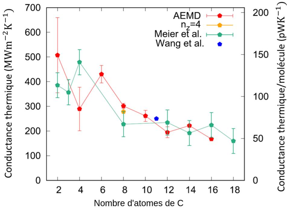
FIGURE 3.20 – Conductance thermique d'interface  $G$  en fonction du nombre de C par molécule obtenue par AEMD pour  $n_z = 3$  (points rouges) et  $n_z = 4$  (point orange). Les points verts sont les mesures de la Réf. [73] multipliées par un facteur 5. Le point bleu est la conductance thermique entre des réservoirs en diamant obtenue dans la Réf. [66].
