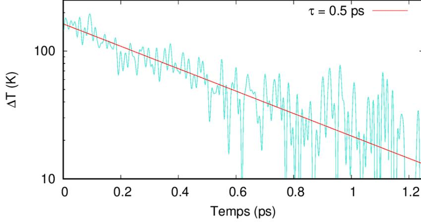
FIGURE 4.7 – Différence de température entre les blocs chaud et froid pendant la phase 2 dans la boîte de aSiO<sub>2</sub> de 558 atomes.
