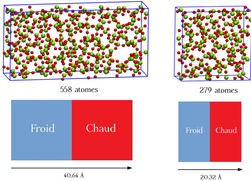
FIGURE 4.8 – Boîtes de simulation de aSiO<sub>2</sub> à section rectangulaire contenant 558 atomes (gauche) et 279 atomes (droite).
