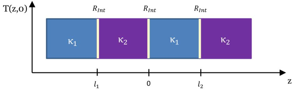
FIGURE 2.3 – Représentation schématique d'un système de périodicité  $l_1+l_2$ , composé de deux matériaux de conductivités  $\kappa_1$  et  $\kappa_2$  réunis par des interfaces de résistance thermique  $R_{Int}$ .
