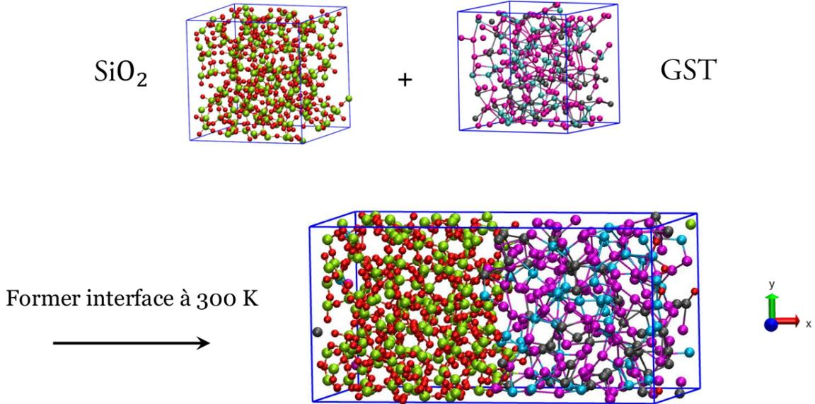
FIGURE 5.3 – Boîte de simulation du aGST-aSiO<sub>2</sub> contenant 810 atomes. Le germanium est représenté en cyan, l’antimoine en gris, le tellure en magenta, le silicium en vert et l’oxygène en rouge.
