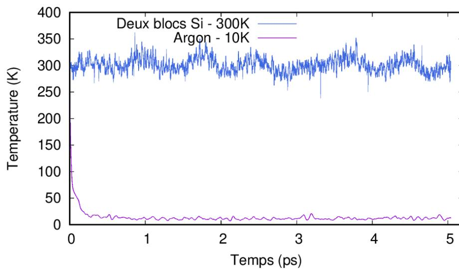
FIGURE 3.32 – Température des atomes d’Ar (violet) et du reste du modèle 2 (bleu).
