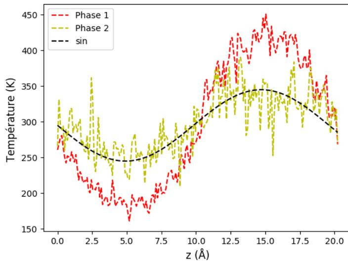
FIGURE 4.6 – Profil de température des phases 1 et 2 dans la boîte de aSiO<sub>2</sub> de 558 atomes. La courbe en rouge (jaune) est moyennée pendant la phase 1 (2). Le profil est sinusoidal pendant la phase 2 (courbe en noir).
