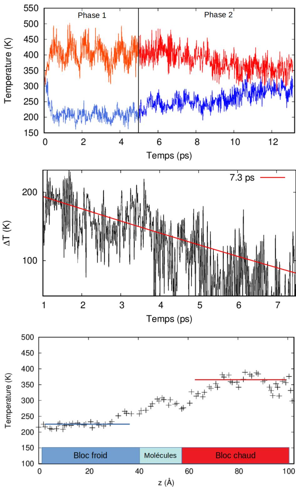
FIGURE 3.11 – Système avec des blocs de Si plus gros ( $n_z = 4$ ) : Trajectoires des blocs chaud (rouge) et froid (bleu) dans l’approche AEMD (haut). Évolution temporelle de la différence de température entre les deux blocs pendant la phase 2 de l’AEMD et ajustement par une exponentielle décroissante (milieu). Profil de température moyenné sur l’intervalle [1-4] ps de phase 2 de l’AEMD (bas).
