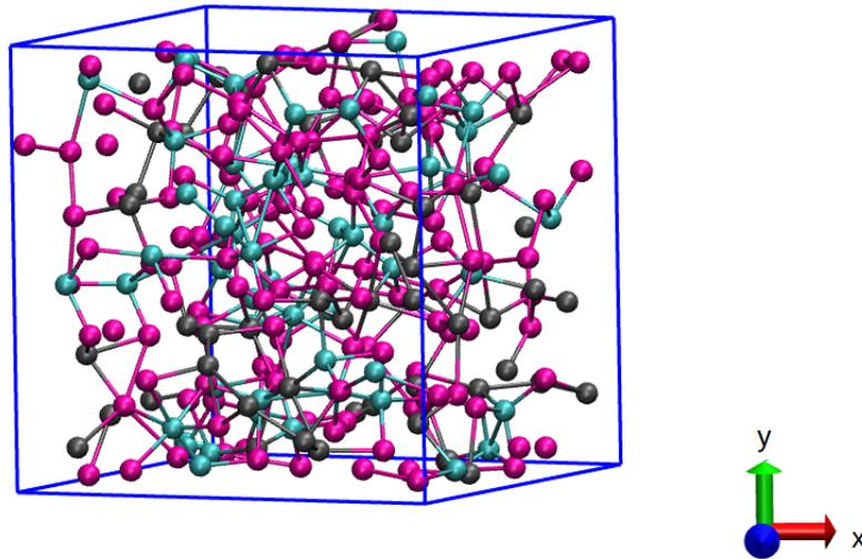
FIGURE 5.2 – Boîte de simulation du aGST contenant 252 atomes. Le germanium est représenté en cyan, l'antimoine en gris, le tellure en magenta.
