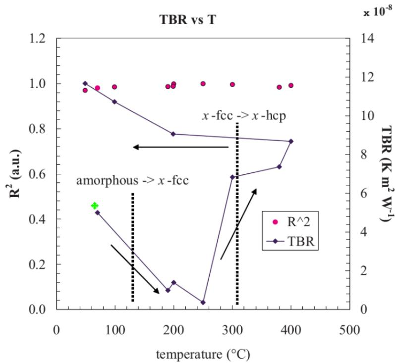
FIGURE 5.9 – Résistances thermiques à l’interface GST-SiO<sub>2</sub> mesurées en fonction de la température de la Réf. [99]. Le point vert est le résultat calculé en AEMD.
