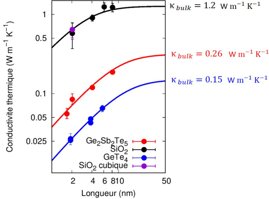
FIGURE 4.10 – Conductivité thermique de la boîte cubique de aSiO<sub>2</sub> comparée aux autres tailles ainsi qu’à deux autres matériaux [41,44,45,47]. Les points sont les résultats de calculs AEMD. Les lignes sont des ajustements par la loi de Alvarez et Jou [106].
