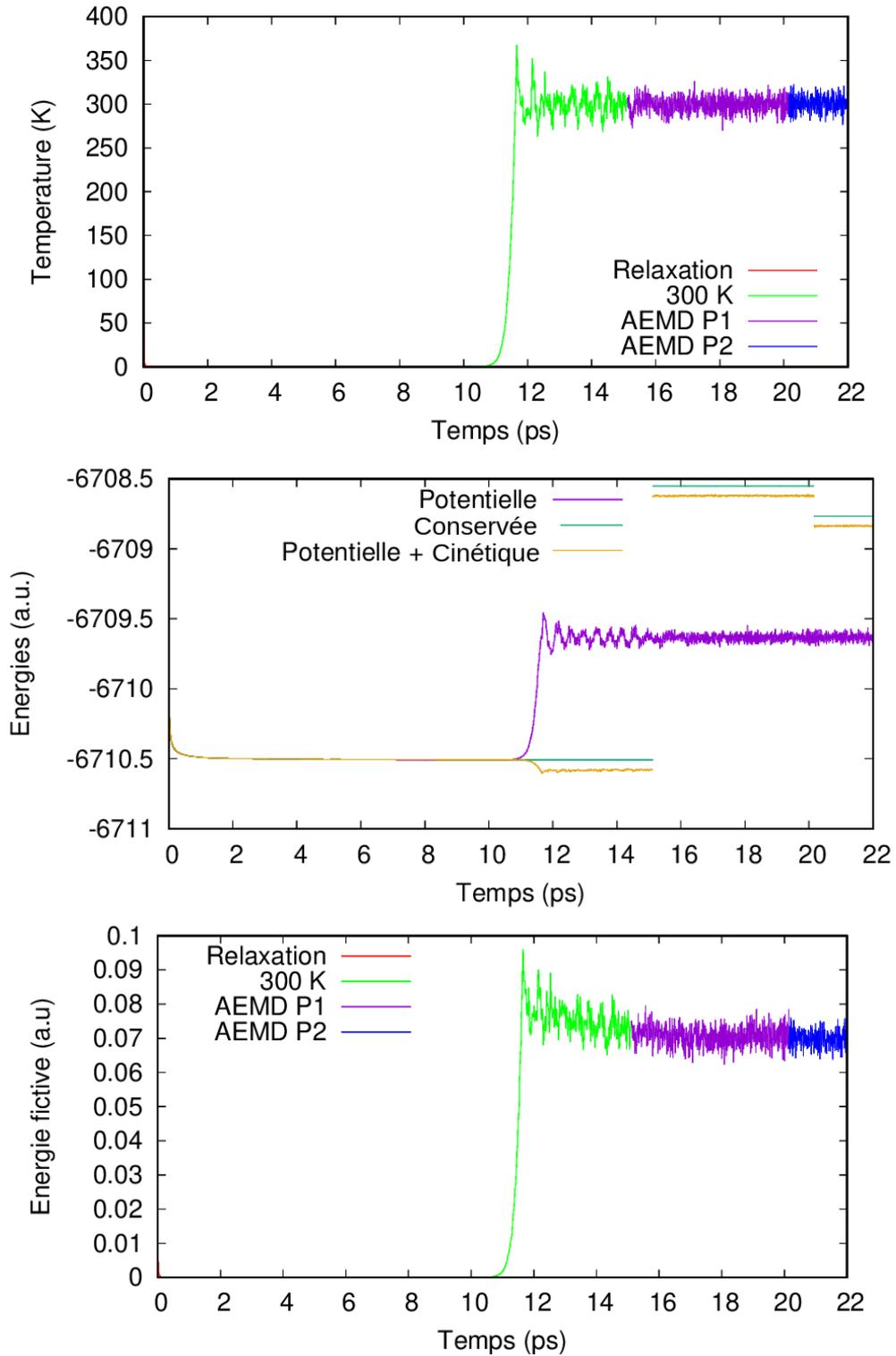
FIGURE 4.3 – Température et énergies du système lors des différentes étapes de simulation pour la boîte de aSiO<sub>2</sub> de 558 atomes.
