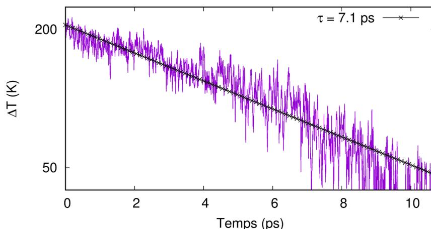
FIGURE 5.7 – Évolution de la différence de température entre les blocs chaud et froid au cours de la phase 2 de l'AEMD avec un ajustement à une décroissance exponentielle (ligne noire). Boîte aGST-aSiO<sub>2</sub>.
