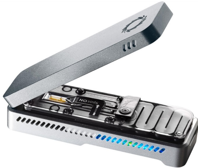
Figure 54 : MinION développé par Oxford Nanopore Technologie
