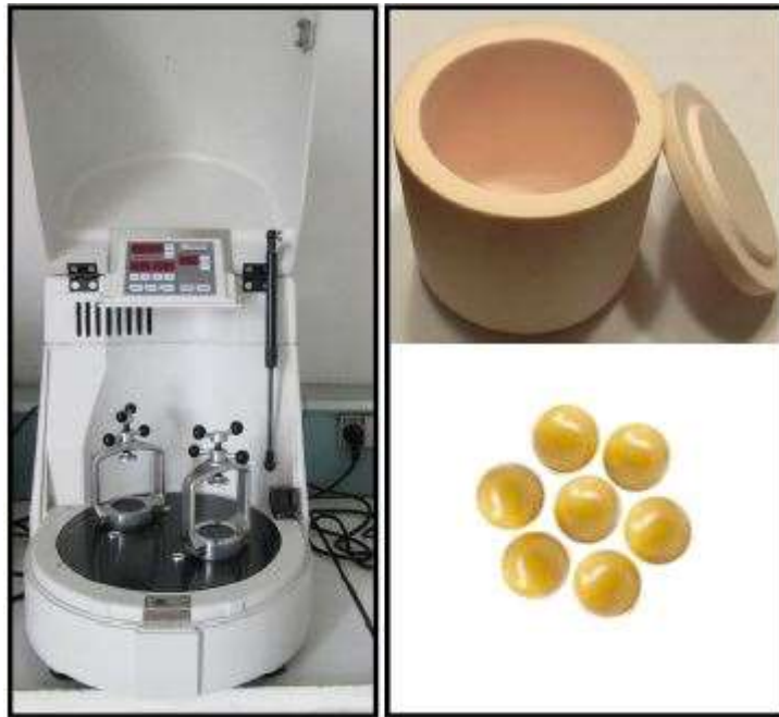
Figure 10: Broyeur planétaire, jarre de broyage et billes de broyage
