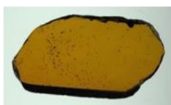
Figure 30. Photo de la vitrocéramique préparée avec le verre \text{Ge}_{25}\text{-As}_{10}\text{-S}_{65} et les particules \text{YNbO}_4\text{:Ho}^{3+} avec un mélange manuel.
