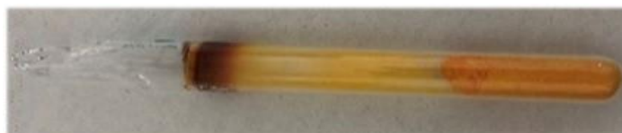
Figure 6. Tube de synthèse en silice contenant le mélange de verre broyé et de particules \text{YNbO}_4\text{:Ho}^{3+} .
