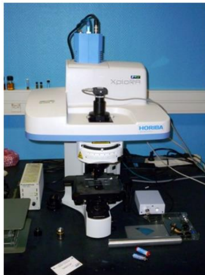
Figure 8. Microscope Raman confocal (Horiba Jobin-Yvon), modèle XploRA.
