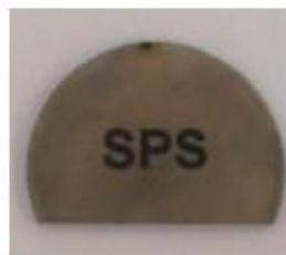
Figure 30. Echantillon de spinelle \text{MgAl}_2\text{O}_4 obtenu par SPS [78].
