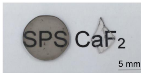
Figure 32. Céramiques CaF 2 (épaisseur de 1 mm) obtenues par SPS avec une feuille de graphite (gauche) ou une feuille de molybdène (droite) placée entre la matrice et l'échantillon [81].
