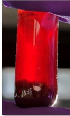
Figure 8. Photo du matériau synthétisé à 775°C pendant 1h dans le four à bascule.
