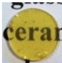
Figure 34. Echantillon obtenu après traitement de préfrittage et traitement SPS [82].
