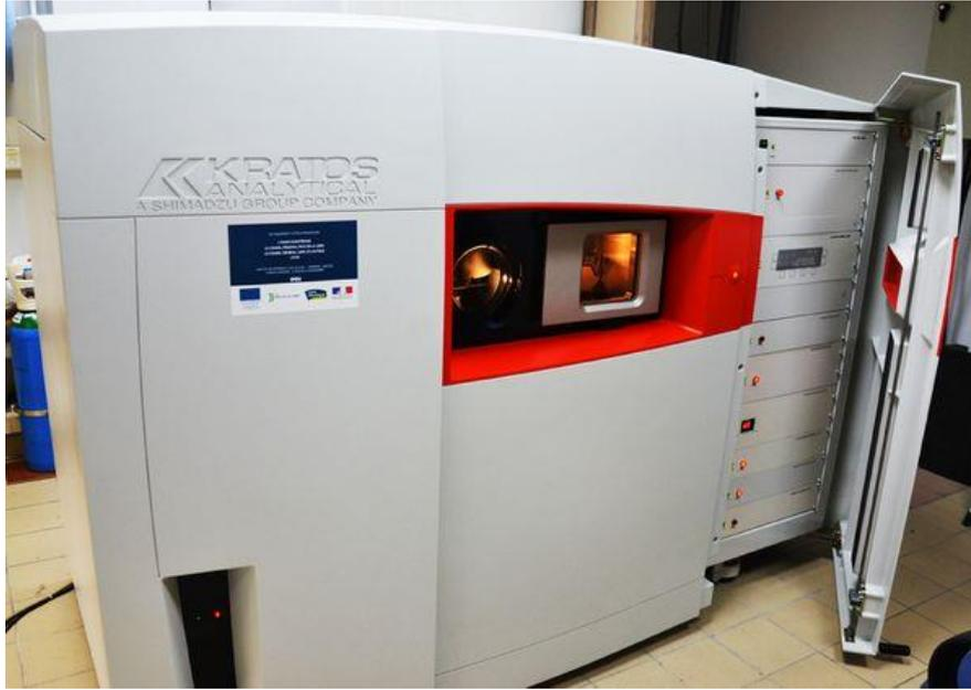
Figure 2.19 - Dispositif XPS modèle Axis Nova (Kratos Analytical) situé à l'Institut des Matériaux à l'Université de Nantes.
