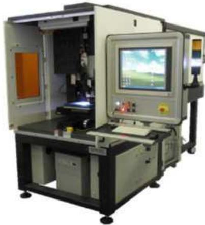
Figure 2.4 - Plateforme MUSE de micro usinage développée par Optec.
