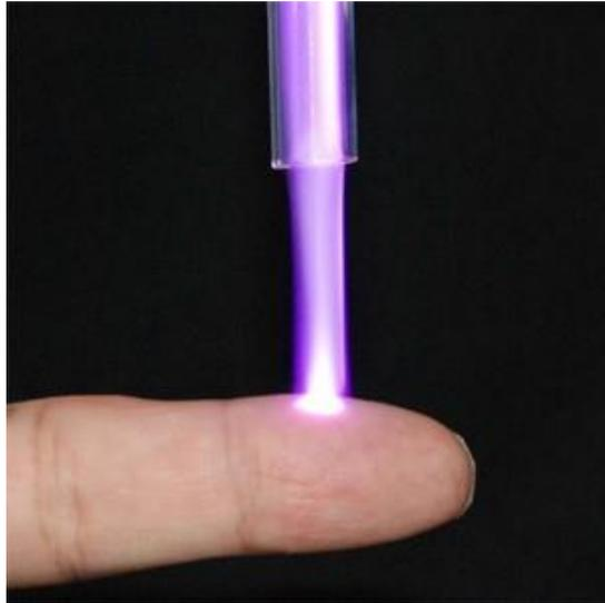
Figure 1.27 - Illustration de la propriété de certains plasmas hors équilibre (plasmas froids) d'avoir une température faible par rapport à la température des électrons.
