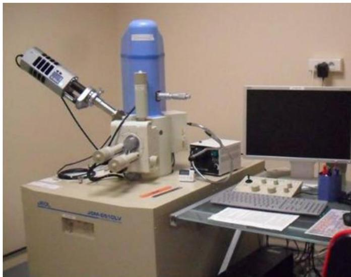
Figure 2.14 - Microscopie électronique à balayage JSM 6510 LV de l'IMMM.
