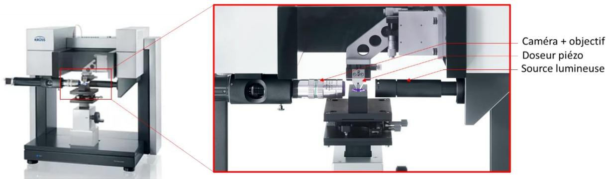
Figure 2.13 - Dispositif de mesure de gouttes picolitres DSA100M de KRÜSS, avec un zoom sur les principaux éléments
