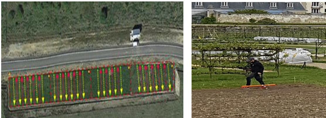
Figure 20 : Prospection EM d'une parcelle : (à gauche) Répartition de la mesure (à droite) acquisition du jeu de données
