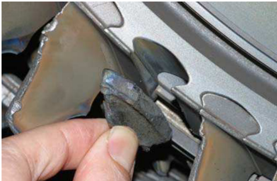
Figure I.9 – Pied d'aube endommagé.
