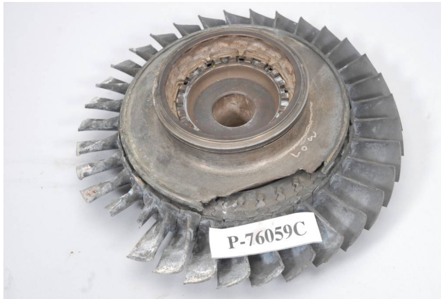
Figure I.8 – Disque et plaque de scellement à l'origine de l'accident aérien de Durban.
