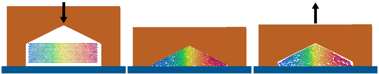
Figure IV.14 – Étapes de compaction du tas de poudre sur MELODY2D.
