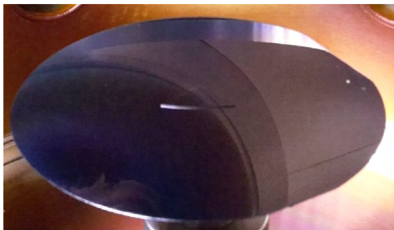
Figure 26. Plaque de Silicium de 10,12 cm de diamètre recouverte de NCD en MEPS, condition Ac du Tableau 1 à 300°C ( \langle e \rangle = 100 \text{ nm} \pm 2 \text{ nm} ; \sigma = 5 \text{ nm} )
