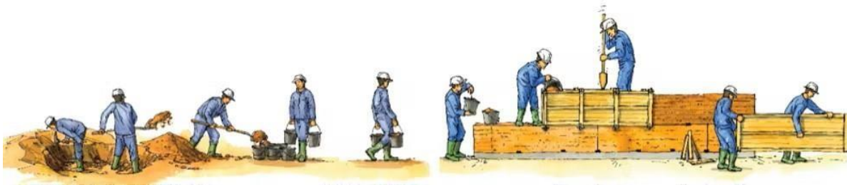
Figure 3: Démarche de construction en pisé [44].
