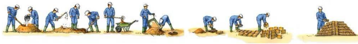
Figure 4: Démarche de fabrication des briques adobe [44].
