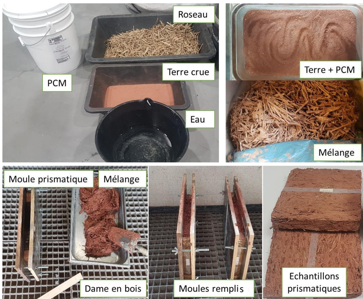
Figure 35: Protocole de confections des éprouvettes.
