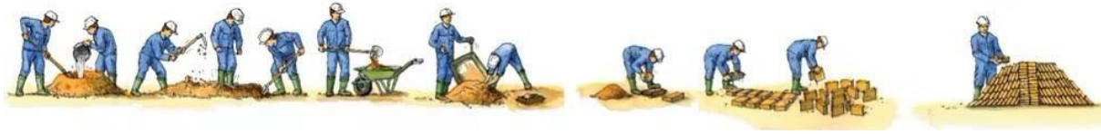
Figure 4: Démarche de fabrication des briques adobe [44].
