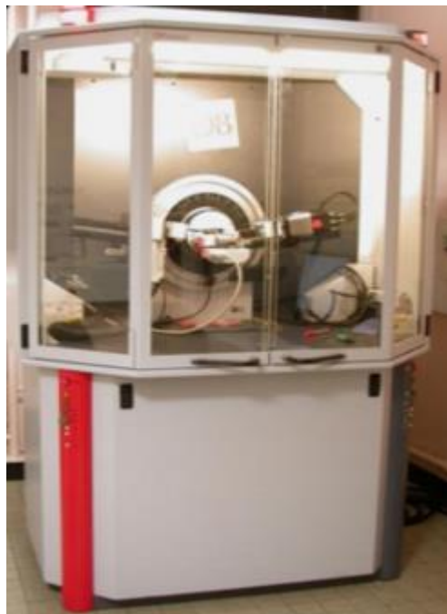
Fig.III.4 Diffractomètre BRUKER-AXS type D8
