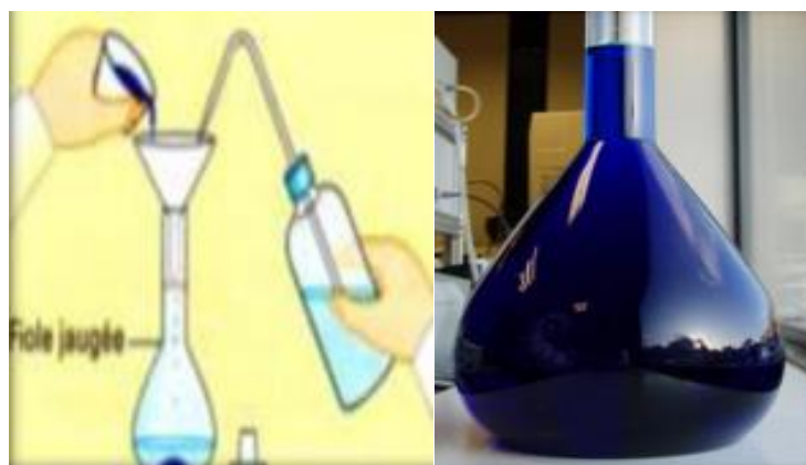
Fig.IV.5 Préparation de la solution du bleu de méthylène
