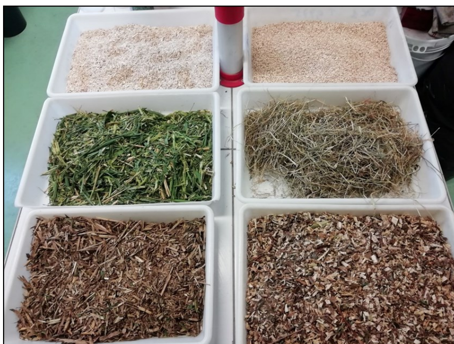
FIGURE 3.5-1 : PHOTOGRAPHIE DES MATERIAUX UTILISES (SAUF BOUES) APRES BROYAGE. DE GAUCHE A DROITE ET DE HAUT EN BAS : PAILLIS DE CHANVRE, RAFLES DE MAÏS, ROSEAUX FRAIS, PAILLES, ROSEAUX D'HIVER ET BRF.
