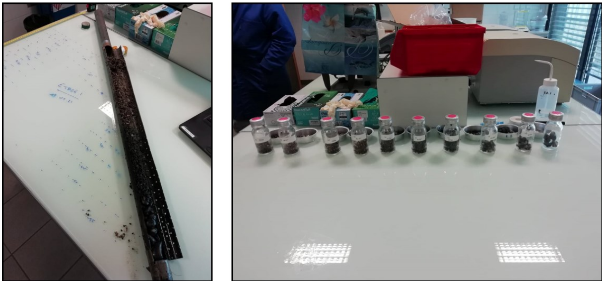
FIGURE 2.4-2 : A GAUCHE, PHOTOGRAPHIE DE LA CAROTTE INTERNE APRES OUVERTURE LE 28 AVRIL 2021. A DROITE, PHOTOGRAPHIE DES FLACONS PLASMA APRES DIVISION DE LA CAROTTE EN HORIZONS.
