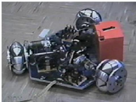
**Figure 2. 9 :** Exemple de plate-forme omnidirectionnelle à roues suédoises.
