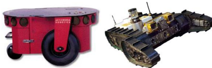
Figure 2. 7 : Exemple de plate-forme différentielle
