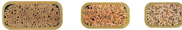
Figure C.4: Différents conducteurs utilisés sur l'aimant hybride 45 T du NHMFL, très différents du conducteur MADMAX.
