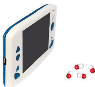
Figure 31 : Dispositif de télémétrie pour suivi de la température corporelle de chez Anipill®.
