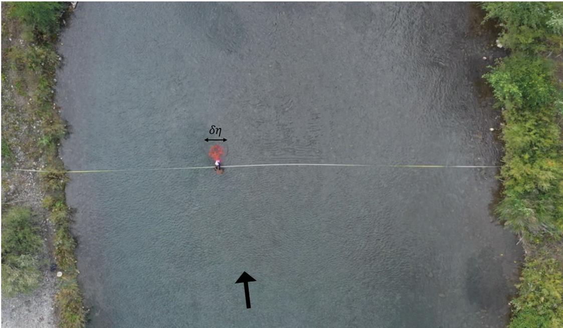
FIGURE 3.8 – Injection d'une quantité connue de Rhodamine WT par un opérateur dans l'écoulement. La flèche noire indique le sens de l'écoulement.  $\delta_\eta$  représente la largeur en débit cumulé de la tache du traceur à l'injection.
