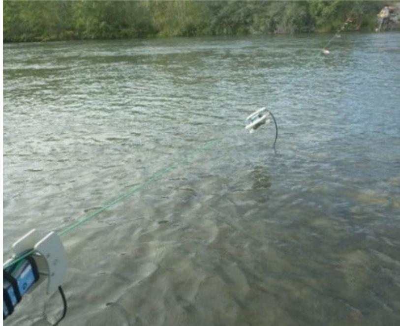
FIGURE 3.21 – Exemple de disposition de sondes de fluorimétrie le long d’une section transverse ; les boîtiers de deux TQ-tracers sont accrochés proches des berges à une corde tendue entre les deux rives de la Durance. Les rubalises visibles sur la corde indiquent la position des sondes Albillias sur cette section.
