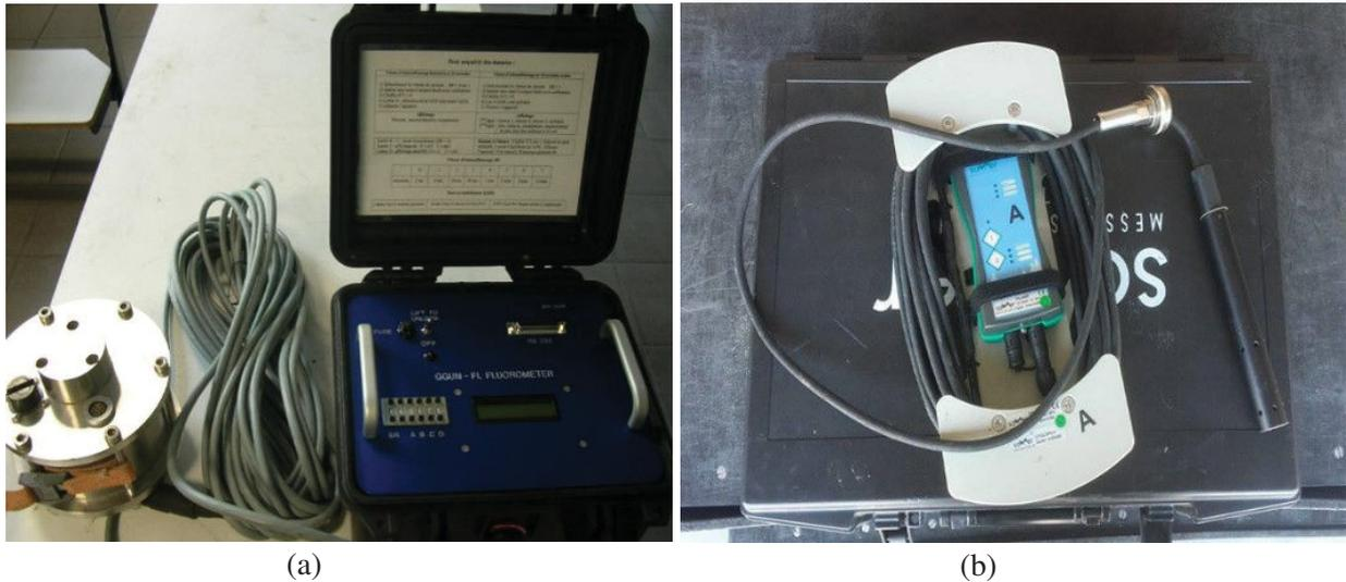
FIGURE 3.20 – Sondes de fluorimétrie utilisées avec leur boîtier : (a) Albillia (série 500) du GGNU, (b) TQ-tracer de Sommer Messtechnik
