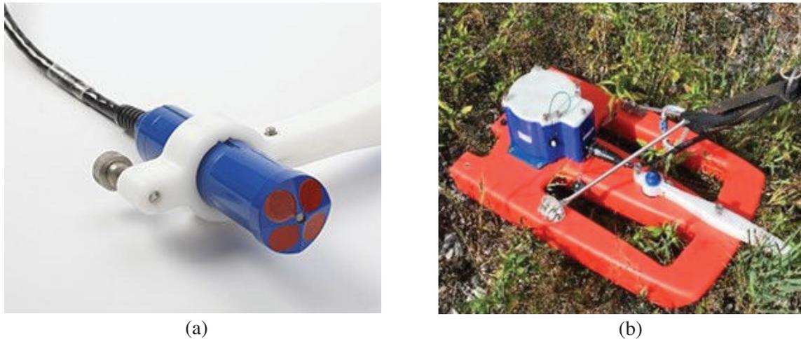
FIGURE 3.14 – ADCP employé dans nos expériences : (a) Sonde Streampro (source : <http://www.teledynemarine.com/streampro>), (b) ADCP embarqué sur une planche flottante
