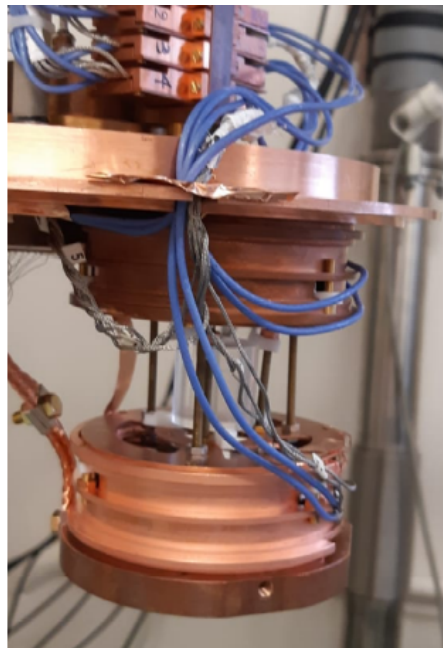
Figure 3: Le prototype de veto extérieur cryogénique (COV) conçu et développé pendant mon activité de doctorat.
