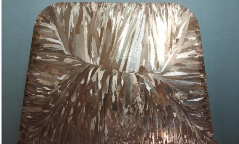
Figure 25 : Observation de la section transverse d'un CROP après attaque chimique. Présence de grains colonnaires qui croissent depuis les bords de l'échantillon vers le centre, qui témoignent du refroidissement imposé depuis les bords du CROP
