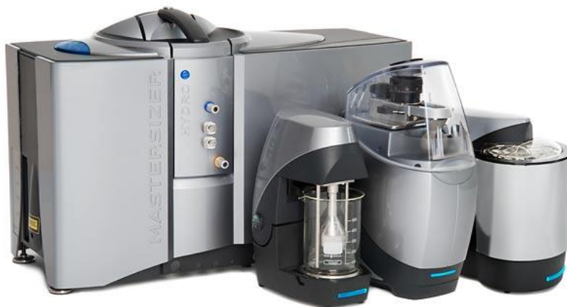
Figure 34 : Granulomètre laser Malvern MASTERSIZER 3000.
