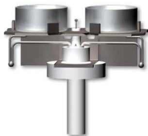
Figure 46 : Schéma de la DSC 131 de SETARAM.
