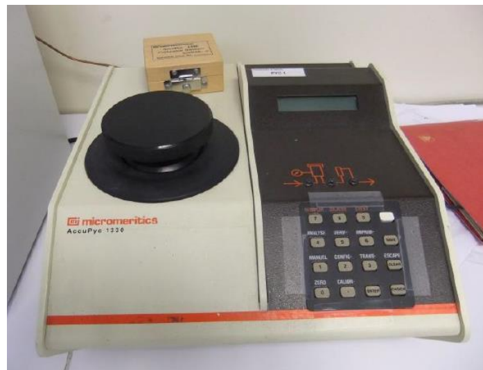
Figure 44 : Pycnomètre à Hélium AccuPyc 1330 de Micrometrics.
