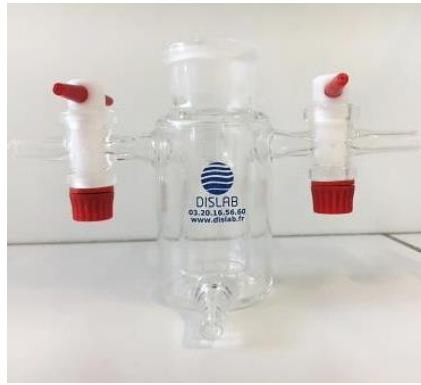
Figure 41 – Photographie de la cellule double paroi utilisée pour la photoréduction.
