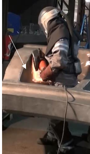
Figure 26 : Ébarbeur meulant une surface verticale lors du geste traditionnel
