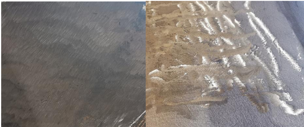
Figure 39 : Exemple de l'aspect visuel d'une surface meulée suite au geste traditionnel (à gauche) et suite au geste cobot (à droite)
