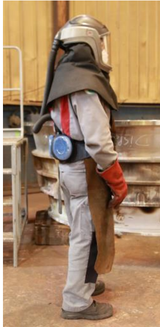
Figure 13 : Illustration des équipements des ébarbeurs
