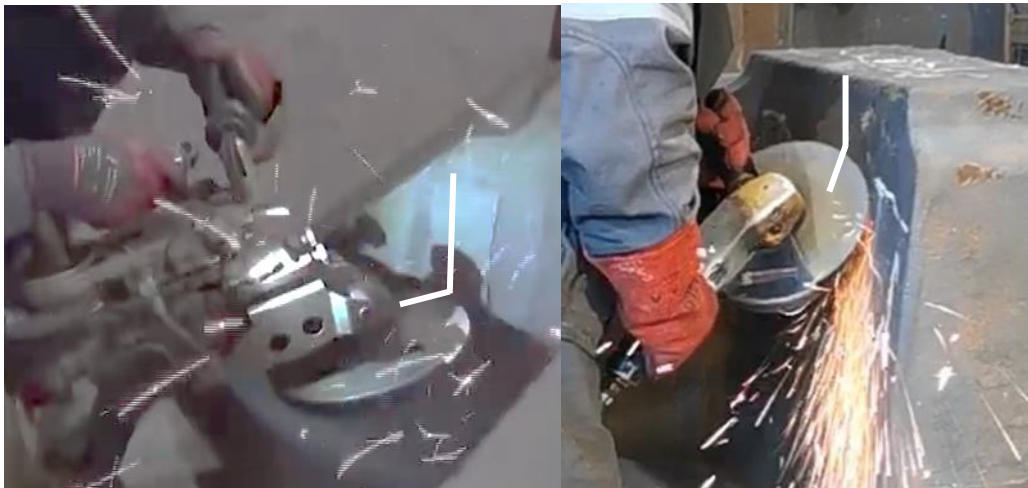
Figure 36 : Illustration des inclinaisons du disque lors du geste cobot (à gauche) et lors du geste traditionnel (à droite)
