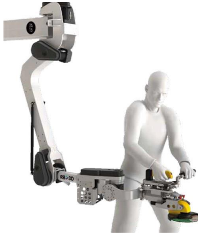
Figure 4 : Robot d'assistance physique sans contention manipulé par l'opérateur (RB3D, 2014)
