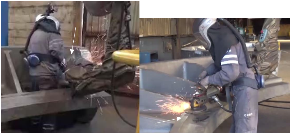
Figure 28 : Ébarbeur meulant une surface verticale (à gauche) et horizontale (à droite) lors du geste cobot
