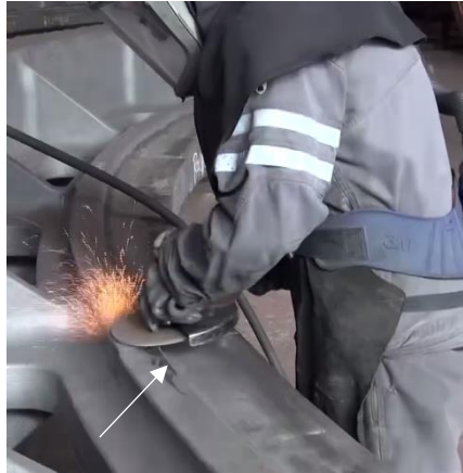
Figure 27 : Ébarbeur meulant une surface horizontale lors du geste traditionnel
