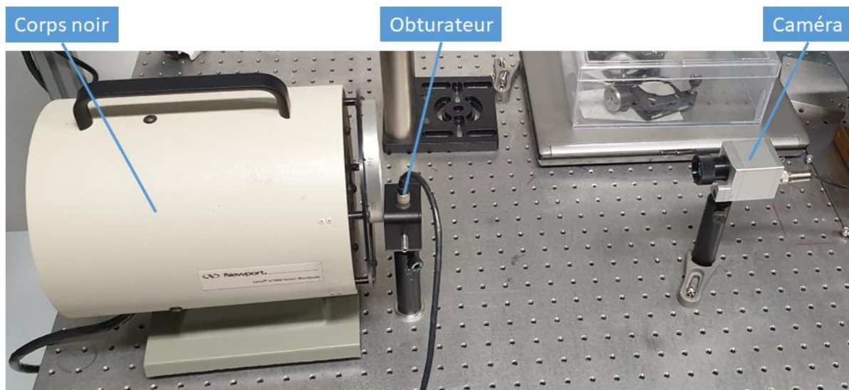
Figure 45 : Montage d'étalonnage thermique du banc de mesure LIT.
