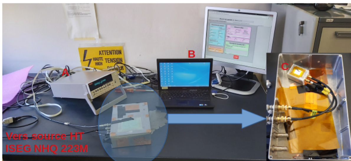
FIGURE 2.3 – Image du dispositif expérimental utilisé pour les mesures de courant de fuite avec nos détecteurs diamant. En A est montré le picoampèremètre/source de tension Keithley 6487 permettant d'effectuer les mesures du courant du détecteur. En B, nous pouvons voir l'ordinateur permettant le contrôle de la source de tension ISEG NHQ 223M et l'acquisition des données via le Keithley. En C est représenté le diamant positionné dans une cage de Faraday afin de minimiser l'influence électromagnétique extérieure.
