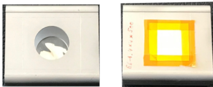
FIGURE 2.12 – Images de la boîte utilisée lors des expériences sous faisceau pour protéger la réponse du bruit électromagnétique
