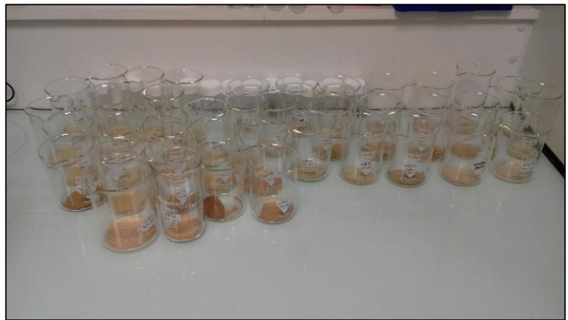
Figure 53. Une série d'échantillons tamisés à 2 mm pour les analyses granulométriques (Photo : M. Stern).
