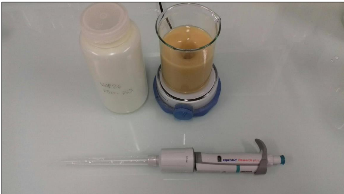
Figure 56. Agitation d'un échantillon au barreau magnétique avant la mesure de granulométrie laser (Photo : M. Stern).
