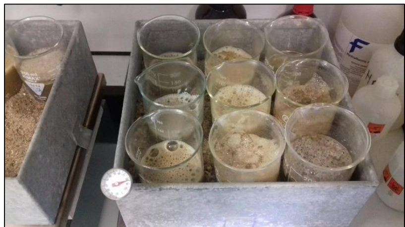
Figure 54. L'effervescence lors des attaques au peroxyde d'hydrogène à chaud (ici dans un bac à sable chauffé) (Photo : M. Stern).
