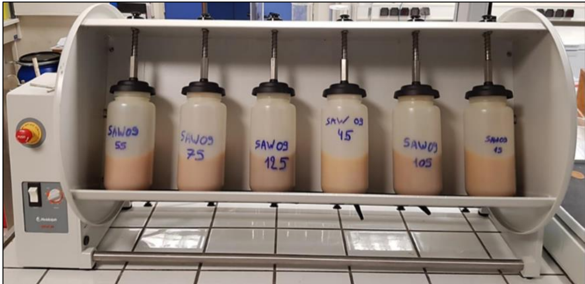
Figure 55. Agitation pendant 12 h des échantillons en solution d'hexamétaphosphate de sodium (Photo : E. Weisskopf).
