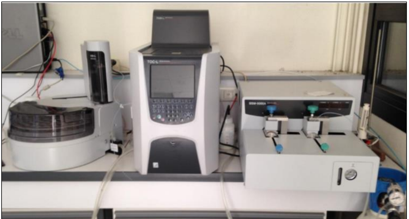
Figure 61. L'analyseur de carbone Shimadzu TOC-L CSH/CSN couplé à un module solide Shimadzu SSM-5000A (Photo : E. Weisskopf).
