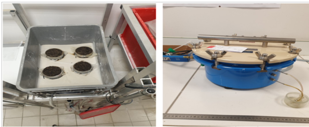
FIGURE 93 – Dispositifs utilisés pour déterminer la courbe de rétention hydrique. A gauche : table de succion ; à droite : dispositif des presses de Richards.
