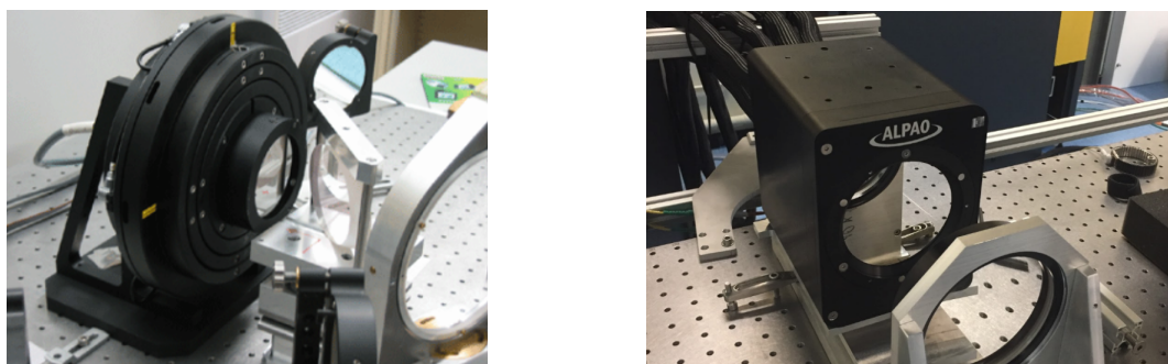
FIGURE 5.2 – Gauche Miroir bimorphe tip/tilt Crédit : É. Gendron et Droite Miroir ALPAO Crédit : F. Vidal.
