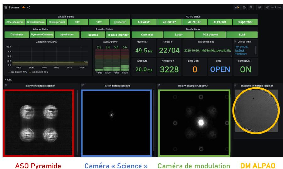
FIGURE 5.3 – Affichage temps réel du statut des outils et caméras du banc avec le logiciel GRAFANA.
