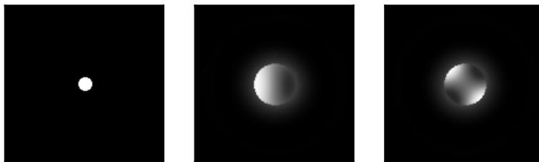
FIGURE 1.19 – *Gauche* Masque de phase de Zernike et images dans le plan du détecteur avec *Milieu* l'exemple d'un tilt selon l'axe "x" (horizontal) et *Droite* l'exemple d'un astigmatisme.
