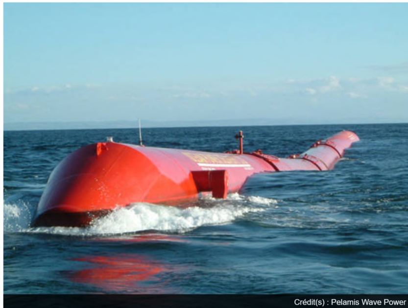
FIGURE 1.3 – Système de captation Pelamis [13]
