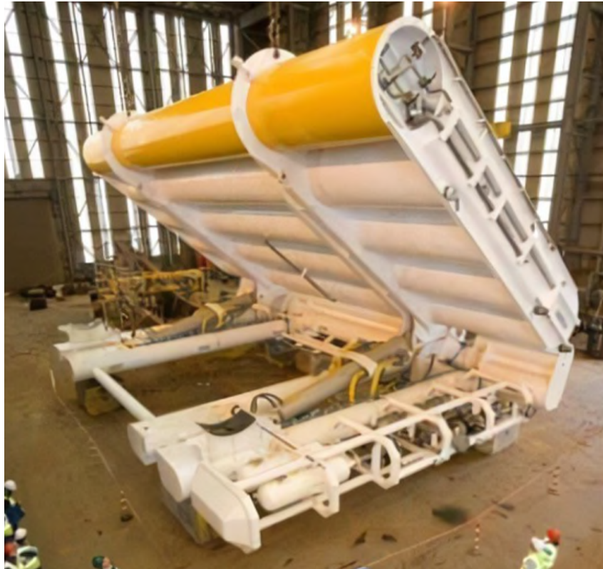
FIGURE 1.5 – Système de captation OYSTER 800 [18]
