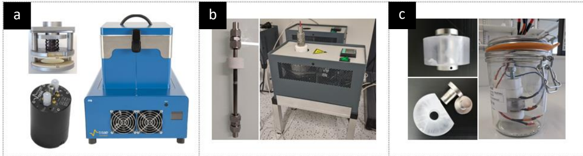
Figure 3-30 : Dispositifs adaptés aux analyses électrochimiques des assemblages tout-solide : (a) cellule CESH et régulateur de température ITS, (b) swagelok en verre pour four tubulaire, (c) matrice ASSB et enceinte en verre étanche.
