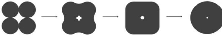
FIGURE 4.5: Mécanisme simplifié du processus de frittage [Yedri et al., 2016]
