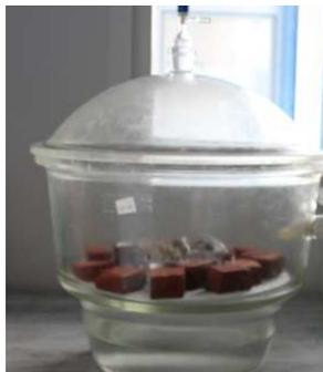
FIGURE 4.20: Essai de sorption des briques en terre cuites
