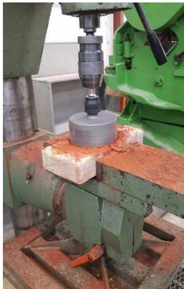
FIGURE 4.25: Carottage des briques en terre cuite
