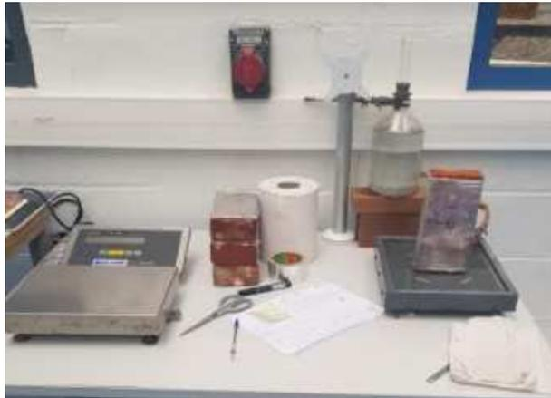
FIGURE 4.15: Absorption d'eau par capillarité
