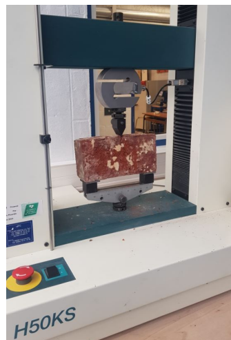
FIGURE 4.13: Essai de flexion 3-points des briques en terre cuite
