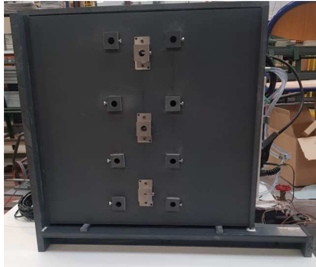
FIGURE 5.7: Mise en place des capteurs sur la plaque
