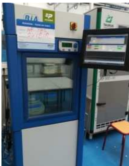
FIGURE 4.29: Enceinte climatique utilisée pour les essais d'identification de la capacité tampon hygrique
