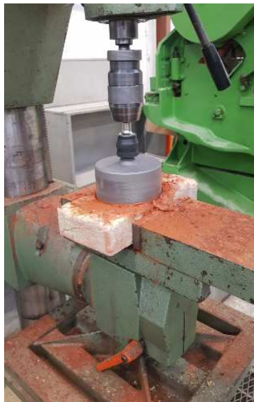
FIGURE 4.25: Carottage des briques en terre cuite
