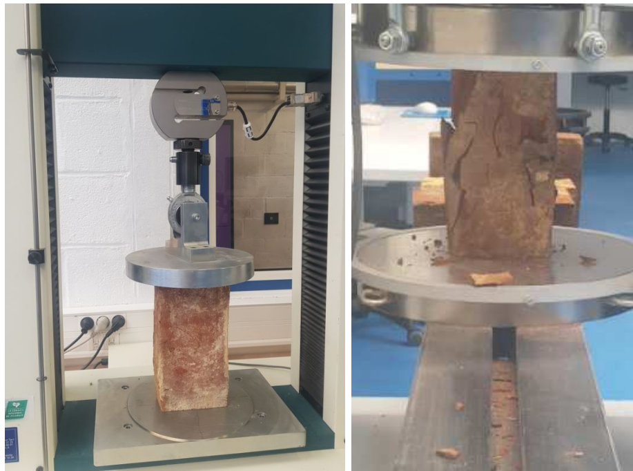
FIGURE 4.10: Essai de compression des briques en terre cuite
