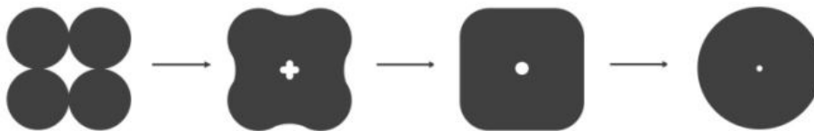
FIGURE 4.5: Mécanisme simplifié du processus de frittage [Yedri et al., 2016]
