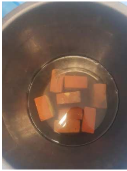
FIGURE 4.24: Immersion totale des briques en terre cuite en terre cuite
