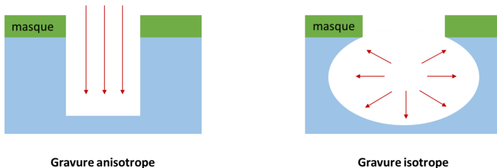
Figure I-3 – Différence entre la gravure anisotrope et isotrope.
