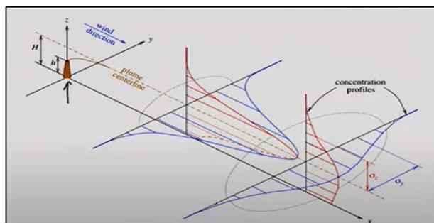
Figure I. 16 : Illustration de la distribution gaussienne d'un panache
