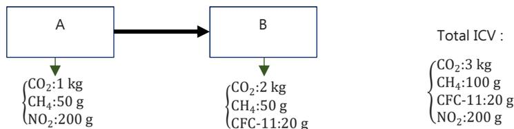
Figure I. 3 : Calcul d'un ICV pour un système fictif composé de deux étapes A et B. Source [Abrassart et al. 2011]
