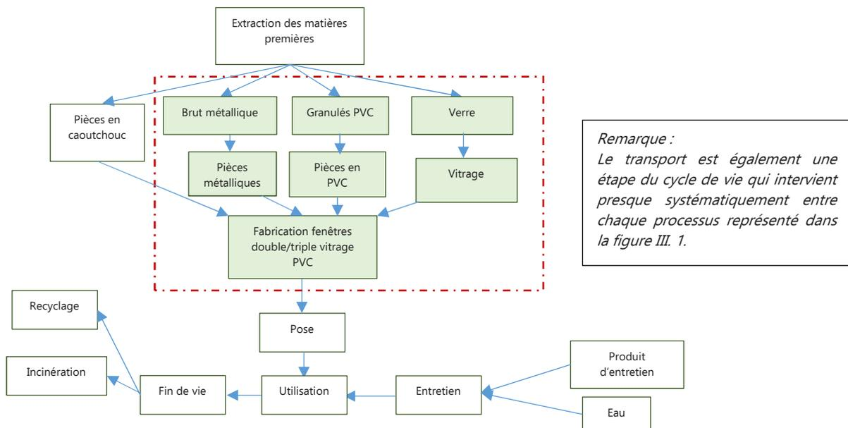
Figure III. 1 : Schéma simplifié du cycle de vie d'une fenêtre double vitrage
