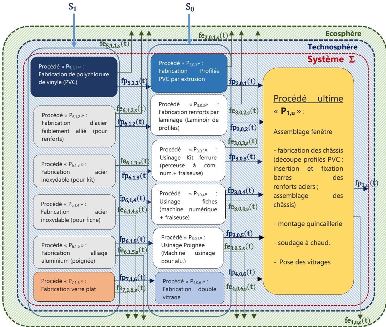
Figure III. 4 : Arbre de processus unitaire d'une baie PVC double vitrage d'1 m<sup>2</sup> de surface
