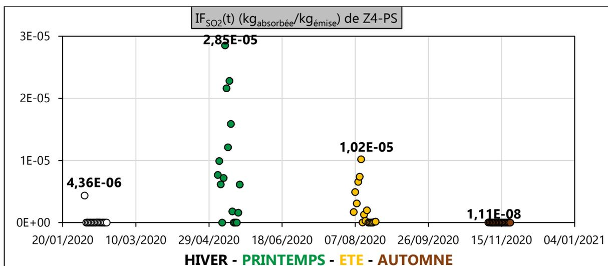
Figure III. 76 :  $IF_{SO_2}(t)$  ( $kg_{\text{absorbée}}/kg_{\text{émise}}$ ) de Z4-PS en 2020
