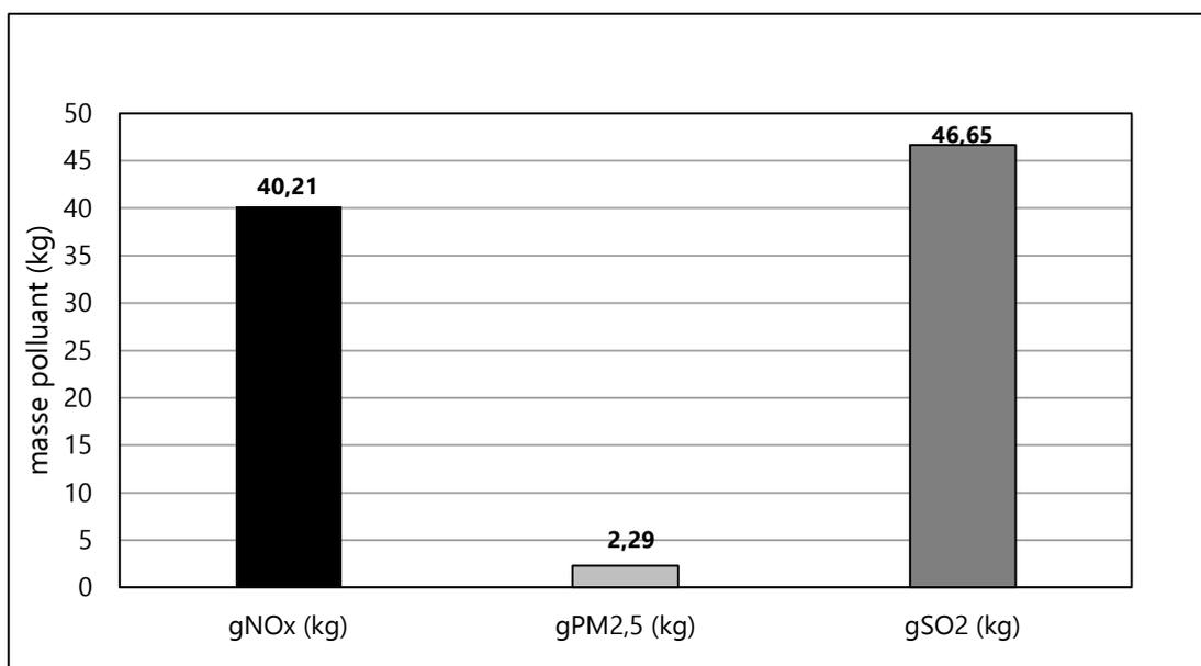
Figure III. 7 : ICV conventionnel du procédé P<sub>7,1,6</sub>
