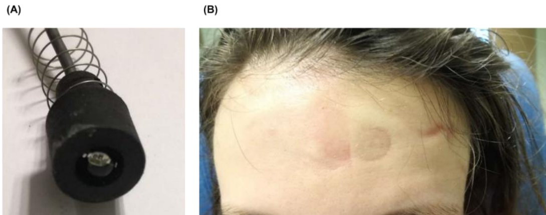
Figure 68 : Problèmes liés aux sources en contact direct avec la peau du sujet. (A) Sources utilisées en V-1 et (B) Empreinte des optodes suite à un positionnement frontal.
