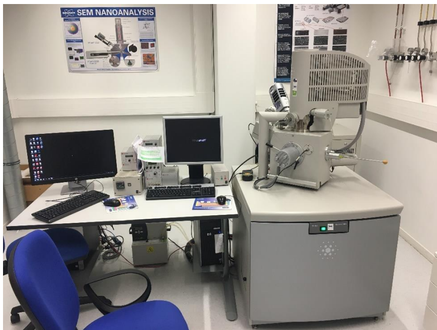
Figure F : Microscope électronique à balayage QUANTA 800FEG équipé d'un détecteur EDX SDD (Oxford 80 mm 2 ), utilisé au LRCS.
