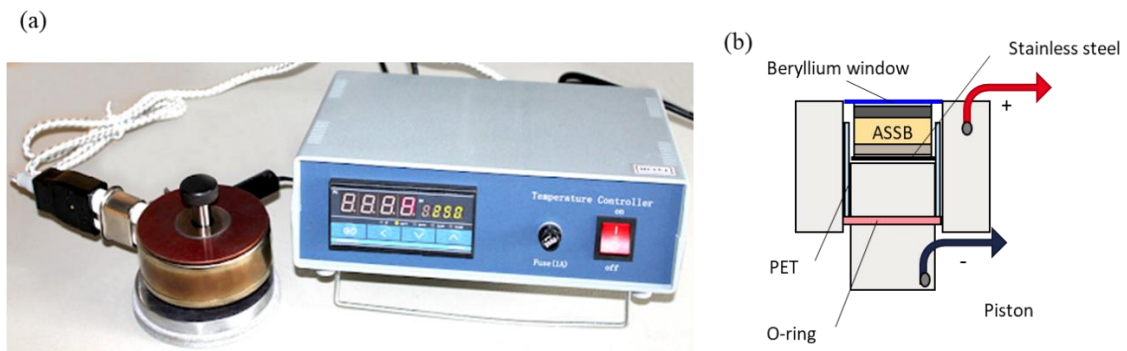
Figure II.52 : (a) Moule chauffant utilisée pour le pressage à chaud de batterie tout-solide de 13 mm ; (b) Montage utilisé pour l'operando DRX
