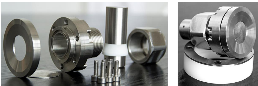
Figure II.7 : Cellule hermétique avec une fenêtre en béryllium utilisée pour la diffraction de rayons X [262].
