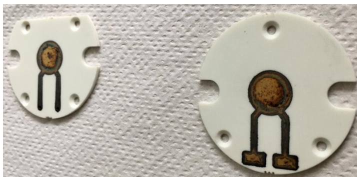
Figure II.21 : Électrodes d'or de la cellule CESH, après quelques utilisations en température
