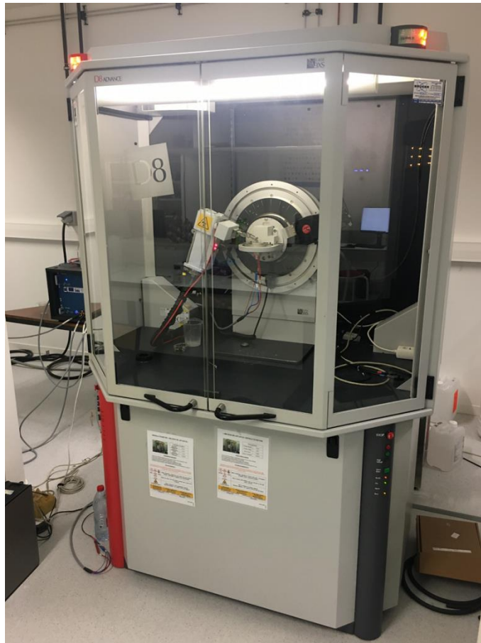
Figure B : Diffractomètre D8 Advance (Bruker) équipé d'une anticathode de cuivre, utilisé au LRCS.
