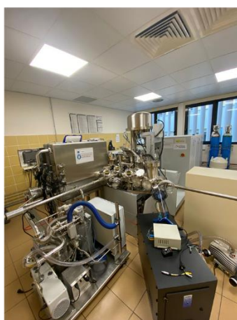
Figure E : (a) XPS Thermo Escalab ; (b) XPS Thermo Kalpha, utilisés à l’IPREM
