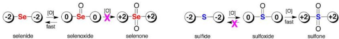
Figure 15. Structures et nombres d'oxydation des composés du soufre et du sélénium qui résultent de réactions d'oxydation à deux électrons
