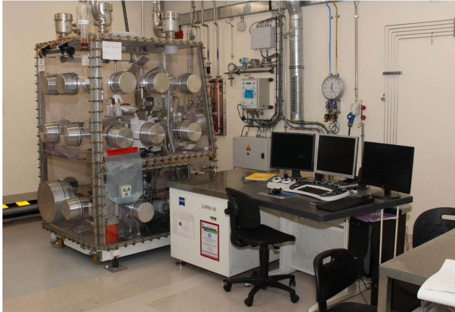
Figure II-7 : MEB SuPRA40 de ZEISS en BàG.
