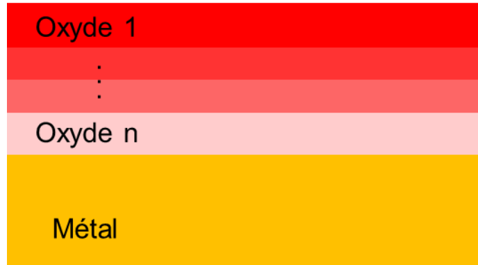
Figure II-3 : Schéma d'empilement de couches d'oxyde.
