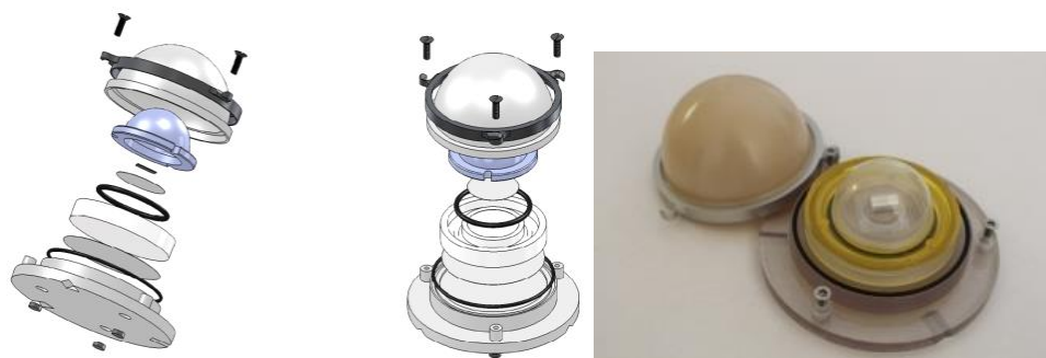
Figure II-15 : a) Schéma du montage double-dôme et b) photo du montage.
